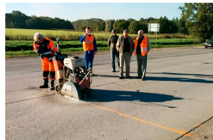
Tallinna-Narva maantee Iru 1967. a. betoontee uuring (fotod: Marek Truu).
