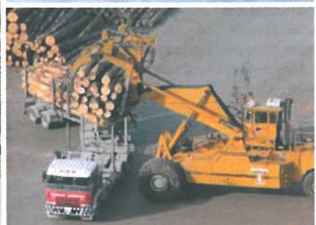
Maanteeametilt kuni 52-tonni erilveola taotlemiseks peavad metsaveomasinad kasutama 7-teljelisi paarisratastega veovahendeid ning veokitele peab olema paigaldatud GPS-jälgimissüsteem.
