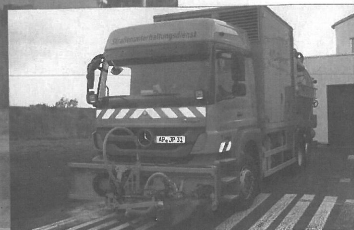
SELLINE masin Saksa firmalt Weigel peseb teelt maha mistahes materjaliga tehtud markeeringu. Nimelt peseb, sest ta teeb seda kõrgsurvepesuri põhimõttel tavalise veega. Eemaldatud sodi imeb ta oma kereesse ja tee on puhas. Aga asfalt on ilusti alles! Samal moel saab selle tehnoloogiaga eemaldada teelt libedaid kohti ja bituumenilalke.
